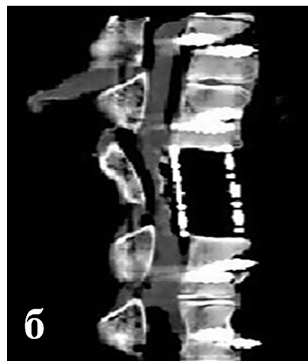
Рис. 4. Модель 8-винтовой транспедикулярной фиксации с опорным спондилодезом сегментарного анатомического блока позвоночного столба свиньи-хрячка после стендового испытания: а — натурная фотография; б — КТ-скан
