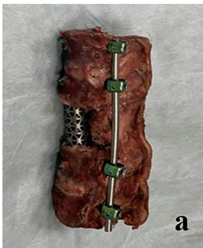
Рис. 4. Модель 8-винтовой транспедикулярной фиксации с опорным спондилодезом сегментарного анатомического блока позвоночного столба свиньи-хрячка после стендового испытания: а — натурная фотография; б — КТ-скан
