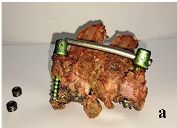
Рис. 1. Модель 4-винтовой транспедикулярной фиксации сегментарного анатомического блока позвоночного столба свиньи-хрячка после стендового испытания: а — натурная фотография; б — КТ-скан
