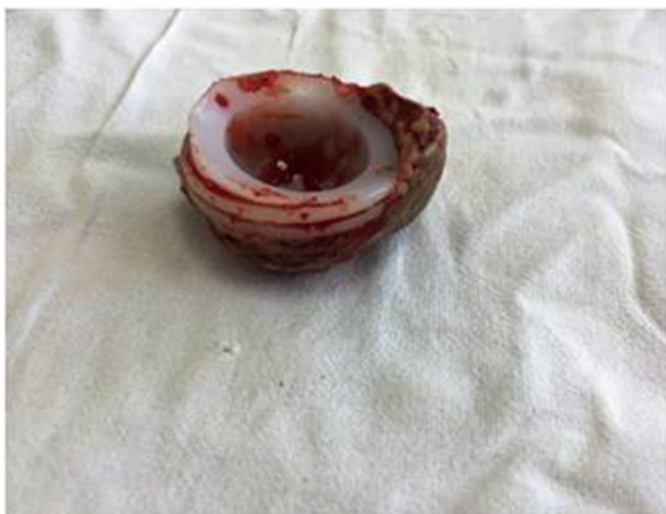
Рис. 3. Удаленная чашка эндопротеза
