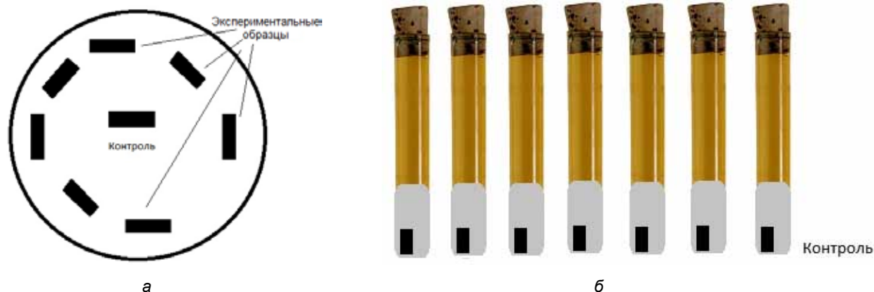
Рис. 4. Схема расположения экспериментальных и контрольных образцов с серебросодержащими покрытиями в ходе эксперимента: а – в чашке Петри; б – в пробирках с сахарным бульоном и культурой золотистого стафилококка
